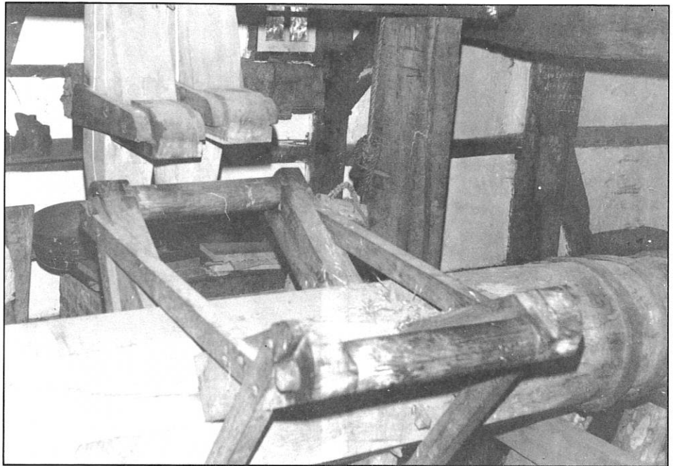
Wentelas met hefen of armen: driemaal per omwenteling grijpt de heef een vuistwig of hefblok van de heibalken.
